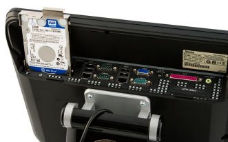
Durchdacht bis ins kleinste Detail. Schneller und werkzeugfreier Zugriff auf alle wichtigen Hardwarekomponenten erleichtern und beschleunigen im Servicefall die Arbeit.
